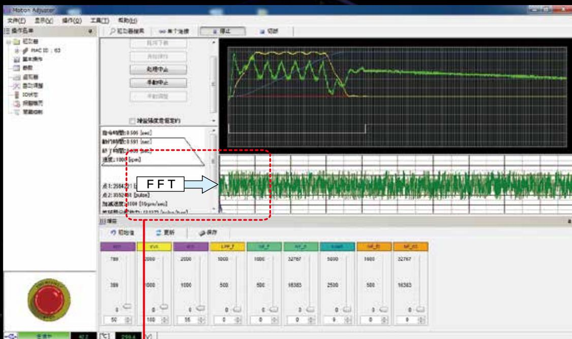
用FFT功能可在个人电脑画面里显示整个装置的震动波形。
